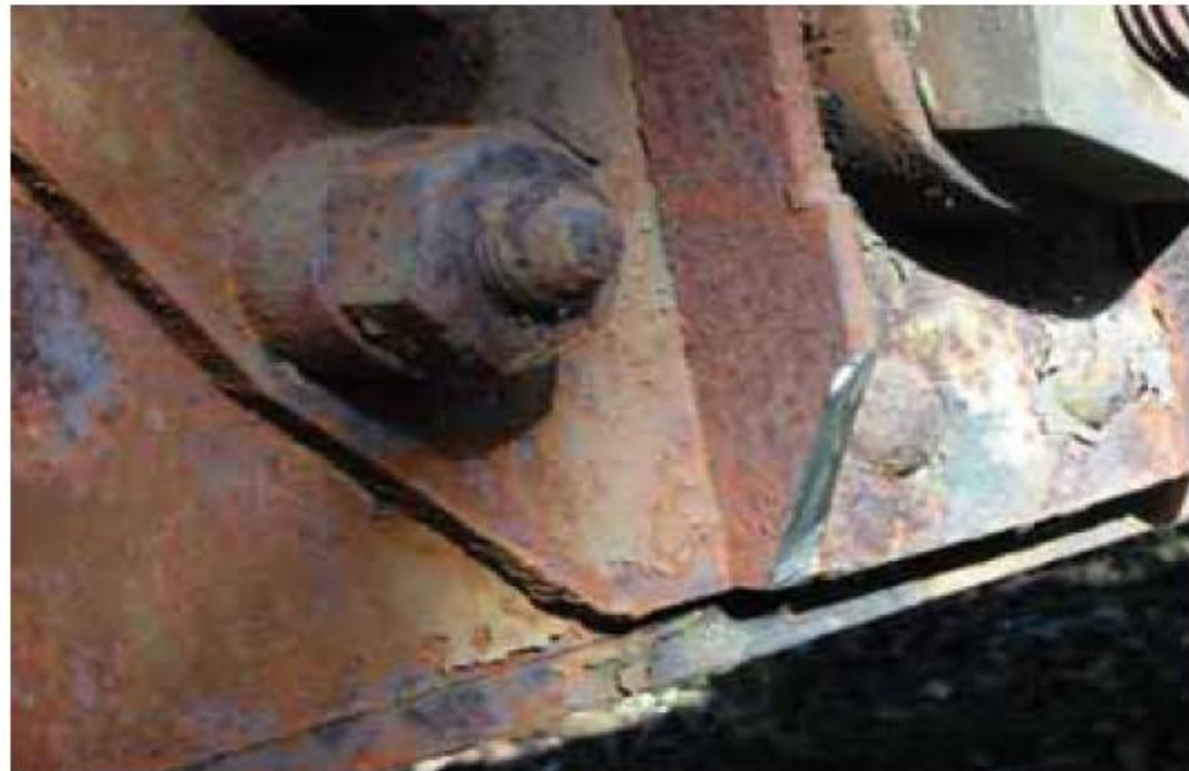
Fig. 27 : Prélèvement en extrémité de pièce pour analyse chimique et examen métallographique.
