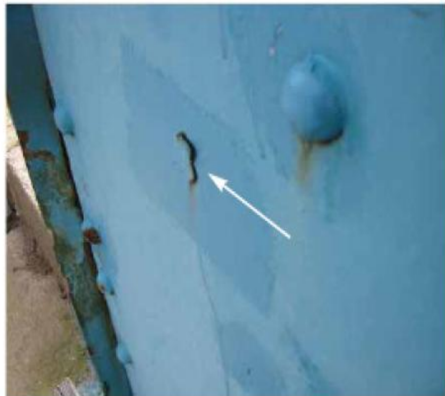
Fig. 26 : Pailles sur éprouvette d'essai et sur ouvrage
